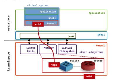
Le rôle du commutateur virtuel *Open vSwitch* est justement de gérer les commutations de circuits et de paquets en coopération avec le sous-système réseau du noyau Linux du système hôte. Ses performances dépendent donc directement des composants disponibles sur le système hôte. Dans le contexte de cet article, il présente un avantage indéniable, il se manipule exactement comme un commutateur réel. Voyons les schémas de topologies types étudiées.
