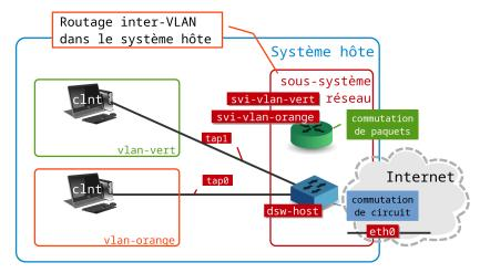
Dans le second exemple, la fonction de routage (commutation de paquets) est assurée par une instance de système virtuel. De plus, on illustre la cascade (*stacking*) entre commutateurs virtuels.
